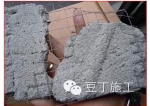
钉挂在墙面上的钢网未张拉牢固，其在抹灰过程中不可避免会出现回弹的问题，抹灰层就难以确保密实了。
